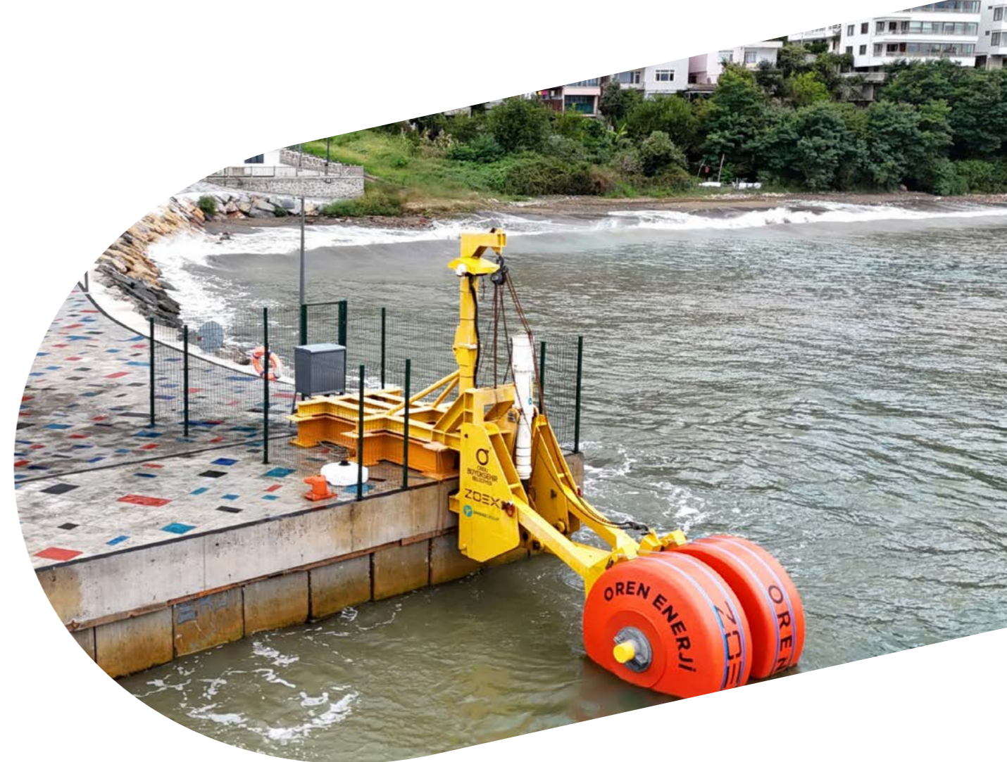
▲ Il Power Take Off di UMBAGROUP installato sul Wave Energy Converter di ZOEX.
