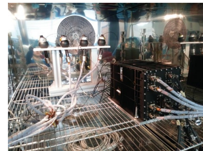
Il Qualification Model (QM) del rivelatore HEPD-02 nel corso del pyroshock test al SERMS (dicembre 2022).
