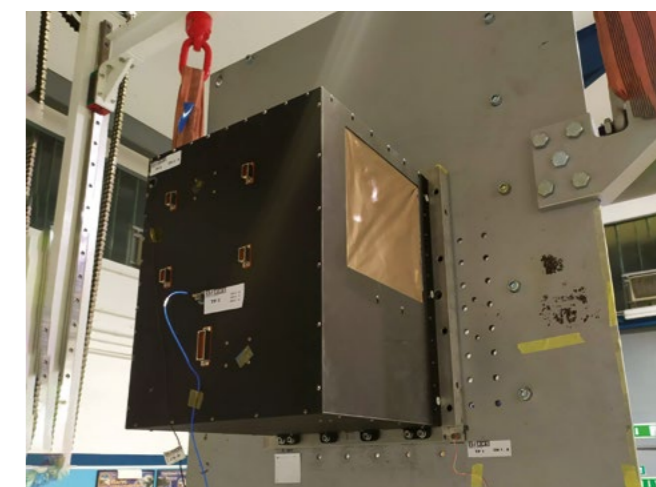
Il Flight Model (FM) del rivelatore HEPD-02 nel corso del test di vibrazione al SERMS (febbraio 2023).
