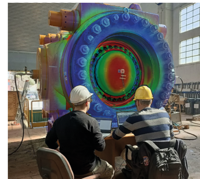
Valvola strumentata con estensimetri e sovrapposizione grafica delle tensioni.
