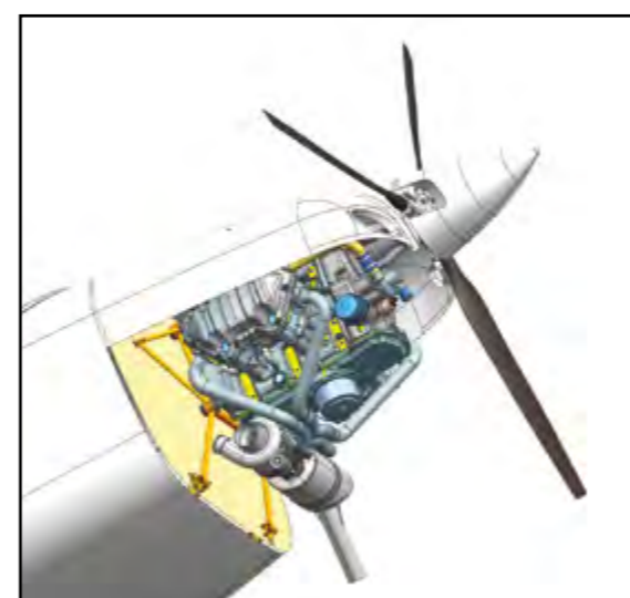
Vista dell'installazione del motore ibrido CMD22, immagine concessa da CMD S.p.A.
